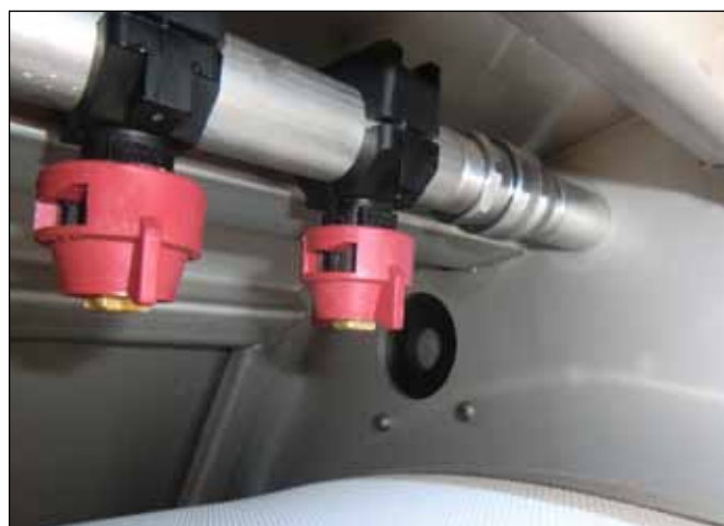
Spulebom med "click" on dyser og lyn kobling.
